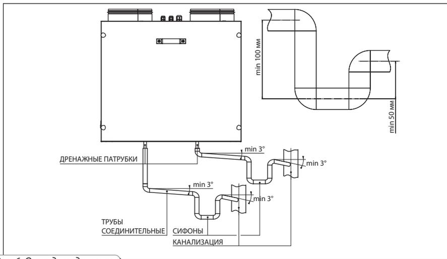
Рис. 6. Отвод конденсата
