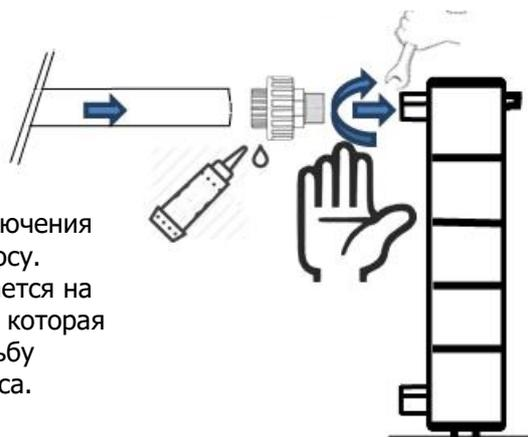
На рисунке: Модель подключения воды к тепловому насосу. Напорный шланг наклеивается на муфту с наружной резьбой, которая закручивается на резьбу теплообменника насоса.
