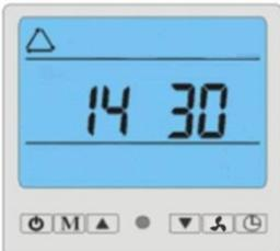
На изображении: Проверка параметров, температура входящей воды 30 ° С.
