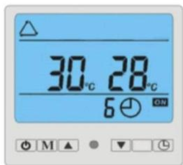
На изображении: Таймер включен.
