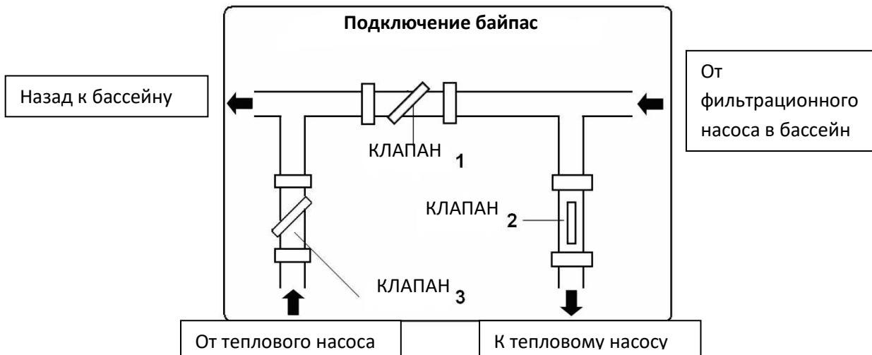
Места подключения теплового насоса оснащены резьбами для входных и выходных фитингов (d50). Для подключения к схеме фильтрации используйте ПВХ трубы d50 или переходники 50/38 мм (6/4). Пожалуйста, обратитесь к разделу 3.4 Описание основных деталей, чтобы узнать какие места подключения представляют собой вход воды и выход воды. Перед затягиванием соединения рекомендуется смазывать их маслом.
