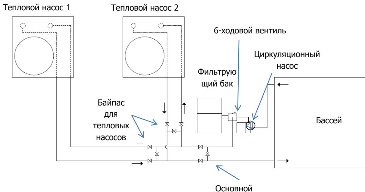
Посредством подключения нескольких тепловых насосов, возможно, установить постоянный нагрев / охлаждение бассейна, или постепенное включение или отключения тепловых насосов, так как при определённых условиях не все тепловые насосы работают. (Например, когда запрашиваемая температура воды
